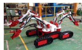
4本の腕と4輪のクローラで動作する小型無人作業ロボット「Octopus (オクトパス)」
