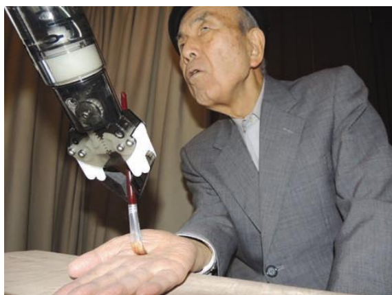
写真1 ロボットアームに絵筆をつけ、手のひらに文字を書く実験の様子
