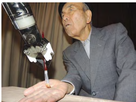
写真2 ロボットアームに絵筆をつけ、手のひら書きをする実験の様子
